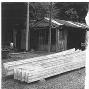
船大工は良い材を選んでよく乾燥させる
