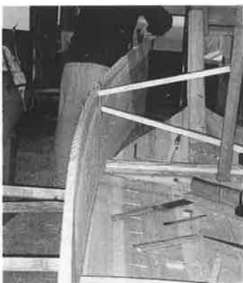
板を曲げて曲線を出すのも船大工の技
