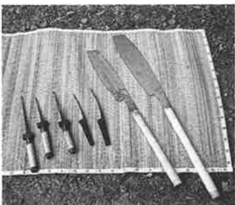
船大工の道具の中でも独特のノコ（右）とツバノミ（左）
