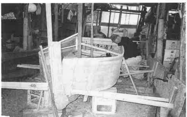
先端（ミヨシという）に向かって板を曲げる
